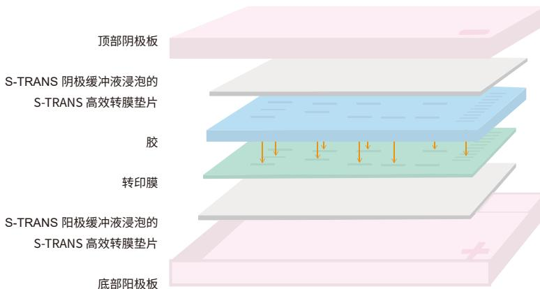
将转印“三明治”结构放置于转印盒的中心，如结构在盒中稍微偏离中心，则无需做移动，放入转印盒后请立即盖上转印盖，确保电气触点紧密配合底座的槽。将盒盖上的销锁杆向盒中心拨动并用力按下盒盖，再放开杆，盖销插入锁定槽。完成后将转印盒滑入主机盒槽中，推至接触联锁并锁定，此时触控屏背景色由亮白色变为灰色。
