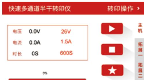
界面左侧显示电压、电流、时间参数。
